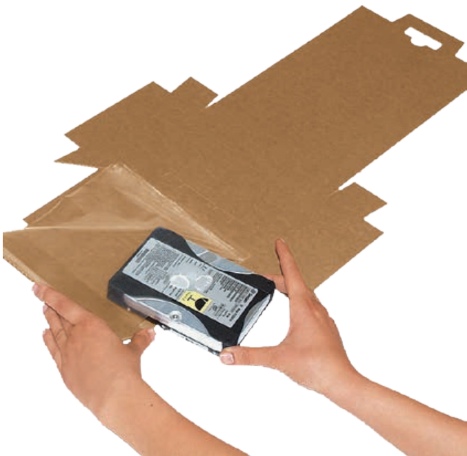
Křídlo se odklopí a balený výrobek se umístí pod fólii.
